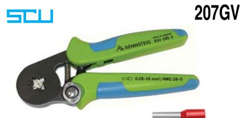
Tipo a regolazione automatica delle ganasce di serraggio. Regolazione manuale della pressione di serraggio. In acciaio speciale, parti operanti temprate e rettificate. Impugnature ergonomiche in materiale bicomponente. Con dispositivo di sbloccaggio in caso di cablaggi difettosi. Per cablaggi a sezione quadra e inserimento frontale del terminale a bussola.
