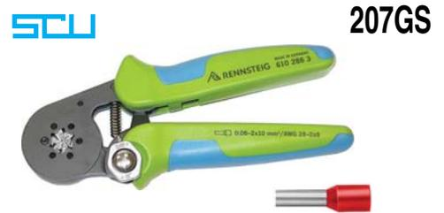
Tipo a regolazione automatica delle ganasce di serraggio. In acciaio speciale, parti operanti temprate e rettificate. Impugnature ergonomiche in materiale bicomponente. Con dispositivo di sbloccaggio in caso di cablaggi difettosi. Per cablaggi a sezione quadra e inserimento laterale del terminale a bussola.
